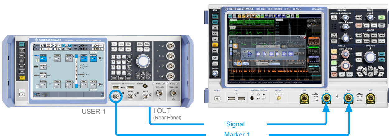
図 4-7: 信号モニタの簡易試験セットアップの説明図*
